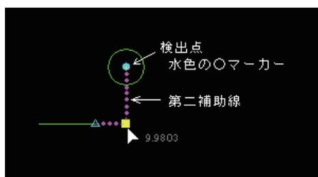
マウスが基準点から、XY方向に動くと上下左右にある特異点（端交点、円/円弧の中心点と90度点）を自動的に検出し、そこから第二補助線を表示します。
