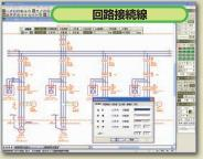
電気回路の回路接続線(操作線·制御母線・主母線)、交点、 交差、区分線、連結線を作図する機能。電気シンボルの 配置されている部分は回路接続線を分割して作図、逆に 電気シンボルを配置した場合、回路接続線は自動的に分割。
