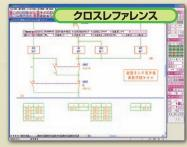
電気回路の接点、コイルの来先、行き先を自動検索し、 デバイス番号・シート位置を作表。
