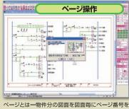
付けて一括処理する為の機能。ページ操作ではページ の追加・挿入・削除・並べ・移動・他図面ページに組込・他 ファイルデータをページに組込・一覧が可能。
