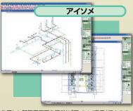
作図した配管平面図を簡単に「アイソメ表示」できます。 継手形状や寸法値、シンボルの表示、非表示も可能。見下 るした角度や回転角度の設定により、平面図ではわかりに くい細部や複雑な配管を自由にシミュレーションできます。
