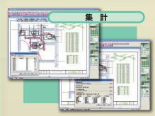
継手・シンボルの個数、直管・サヤ管・冷媒管の長さを集計。 作図同様に重要な作業である集計作業を容易にしました。集計 した継手や直管・サヤ管・冷媒管の情報は、テキストデータに して出力が可能。他のアプリケーションで有効活用できます。
