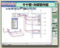
住宅用の給水・給湯によく使用される架橋ボリエチレン 管/ボリブデン管によるサヤ管ヘッダー式配管作図に対応 しました。またビル用エアコンの冷媒配管にも対応しました。
