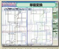
単線から複線、複線から単線へと、ワンタッチで変換可能。今まで煩雑だった作業が簡単になったことで、大幅な作業時間の短縮につながります。
