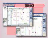
配線修正は「配線の指定による修正」と「シンボルの 指定による修正」の2種類を目的別に選択可能。 「シンボルの指定による修正」ではシンボルと つながる配線・配管をバラメトリックに移動します。
