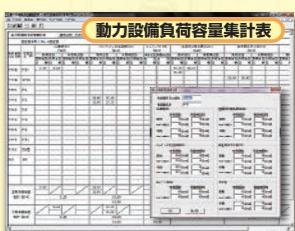
各変圧器の冷凍機、パッケージ形空調機、エレベーター、空調・換気関係など、動力設備の負荷容量を制御盤ごとに集計するプログラム。
