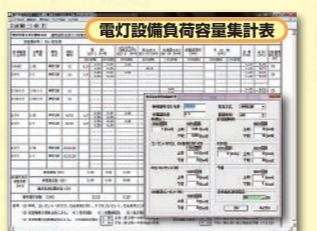
各変圧器の一般照明、コンセント、FCU、非常用照明などの電灯設備の負荷容量を各分電盤ごとに集計するプログラム。
