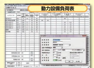
各制御盤の冷凍機、パッケージ形空調機など、動力設備の負荷容量を各機器ごとに集計するプログラム。
