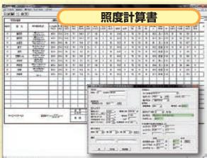
室内の平均照度・照明器具の灯数計算および照明エネルギー消費係数(CEC/L)の計算を行うプログラム。
