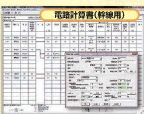
電路(幹線)の負荷容量に対する電線サイズとその電圧降下の計算を行うプログラム。
