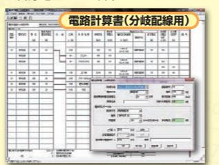
ケーブルラック配線で遮断器定格電流と許容電流遮断率からケーブルサイズを選定し、そのケーブルサイズの合計値からケーブルラックサイズの計算を行うプログラム。
