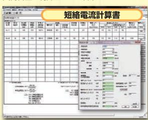
各負荷種別の補正負荷容量の合計値から変圧器容量の計算を行うプログラム。
